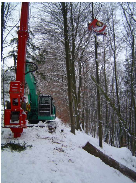
Seilkrananlage mit Laufwagen bei der Bringung von Holz aus dem Steilhang
