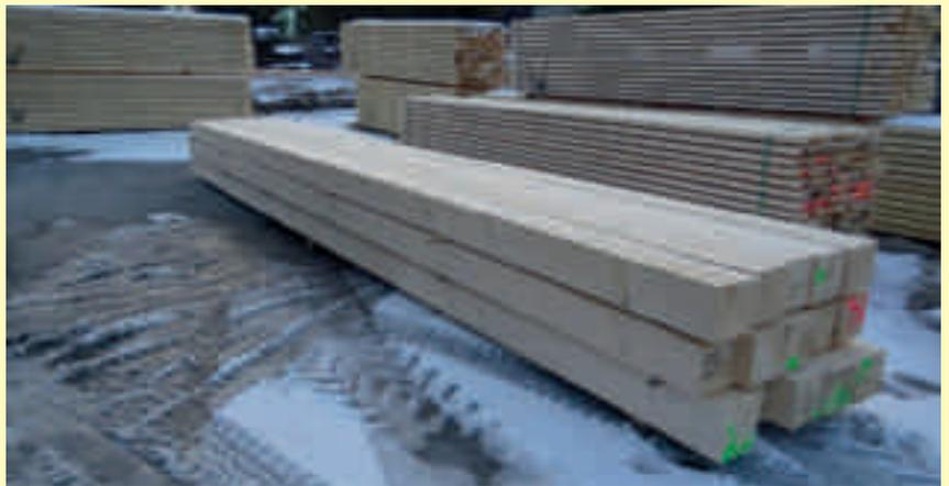
Dieses Bauholz (20x20cm) wurde kerngetrennt eingeschnitten, der Baum also geviertelt. Diese hochwertigen Balken sind die Rohware für die von Architekt Kühnlein geplanten massiven Holzhäuser (Seite 2). Dafür wird frisches, weißes, insektenfreies und starkes Holz benötigt.
